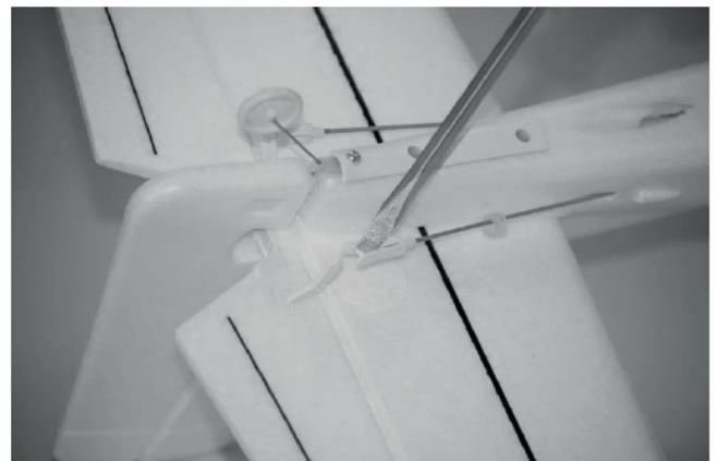
Nachdem Sie beide Gabelköpfe mit den Steuerhörnern verbunden haben, werfen Sie einen geraden Blick von oben auf das Ruder. Es sollte sich in einer Linie mit dem Höhenleitwerk befinden. Sollte das Ruder nach links oder rechts neigen, können Sie die Position der Gabelköpfe/Schubstange anpassen, um die Zentrierung vorzunehmen, während der Trimmhebel weiterhin zentriert bleibt.
