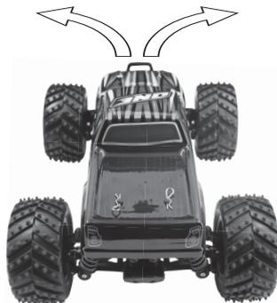
4. Drehen Sie das Rad gegen den Uhrzeigersinn, um nach links zu lenken. Drehen Sie es im Uhrzeigersinn, um nach rechts zu fahren.
