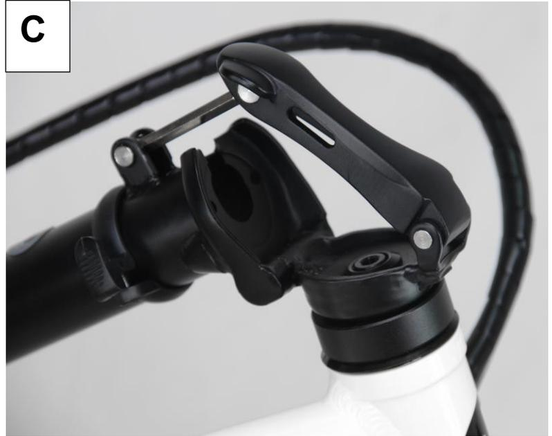
Klappen Sie den Lenker nach unten und achten Sie darauf, dass die Position des T-Griffs korrekt eingestellt ist: Stellen Sie sicher, dass das Vorderrad parallel zum Lenker bleibt (siehe Foto unten mit der Bezeichnung D).
