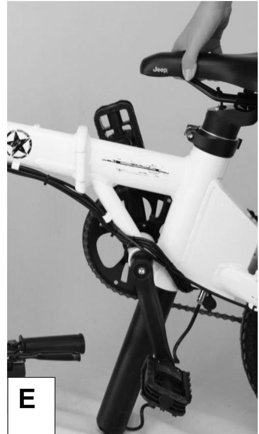
3. Stellen Sie den linken Kurbelwinkel auf 9 Uhr ein (die linke Kurbel zeigt in einem Winkel von  $45^\circ$  nach vorne und unten).
