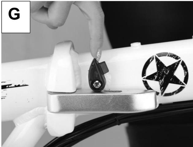
4. Zum Zusammenklappen des Rahmens heben Sie den Rahmenhaken in die geöffnete Position (siehe Foto mit der Bezeichnung G) und öffnen Sie den Verriegelungs-Hebel des Rahmens. Falten Sie den Rahmen in zwei Hälften, indem Sie die vordere Hälfte zum hinteren Rahmen schwenken, bis die beiden Räder parallel positioniert sind. Das Vorderrad muss ungefähr parallel zum Hinterrad sein (siehe Foto unten mit der Bezeichnung H).
