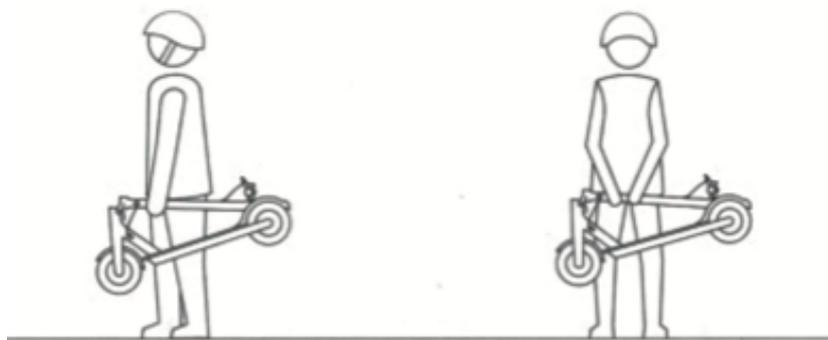
Nach dem Zusammenklappen tragen sie den Scooter mit einer oder zwei Händen, indem Sie ihn an der Standstange anfassen.
