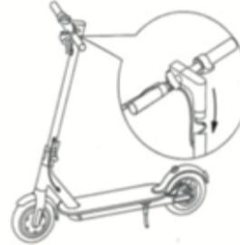
3. Nutzen Sie dabei den Innensechskant-Schraubenschlüssel, um die Schrauben an beiden Seiten festzudrehen
