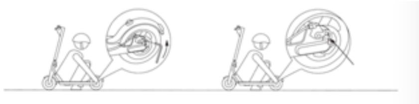
Wenn Sie das Gefühl haben, die Bremse sei zu hart eingestellt, benutzen Sie einen M5 Innensechskant-Schraubenschlüssel und drehen Sie ihn gegen den Uhrzeigersinn, um die Schraube der Bremsscheibe zu lockern. Verkürzen Sie die Bremsdrähte ein wenig und machen Sie die Schraube dann wieder fest. Wenn Ihnen die Bremse zu schwach eingestellt ist, verlängern Sie die Bremsdrähte ein wenig.
