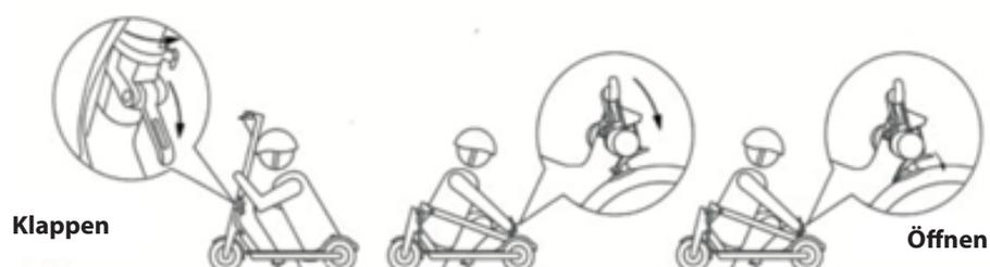
Stellen Sie sicher, dass der Scooter abgeschaltet ist und öffnen Sie die Schraube am Gelenk, wie es auf dem Bild oben zu sehen ist. Legen Sie die Standstange nach hinten und haken Sie sie dort fest. Wenn Sie den Scooter wieder benutzen möchten, lösen Sie einfach den Haken, stellen Sie die Standstange wieder auf und schrauben sie fest.
