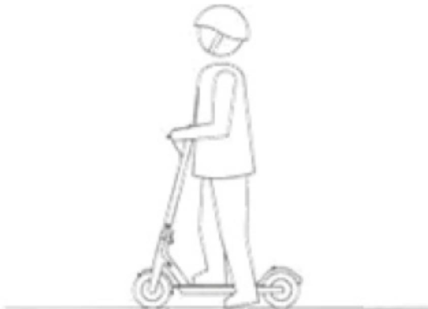
Beim losfahren stellen Sie einen Fuß auf die Fußablage, den anderen lassen Sie zum antauchen am Boden.
