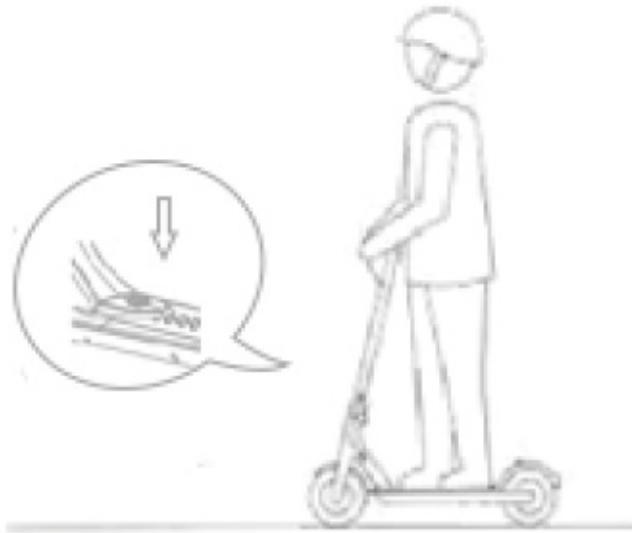
Sobald Sie den Scooter in Schwung gebracht haben und mit beiden Beinen stabil auf dem Scooter stehen, können Sie mit dem Gaspedal langsam Geschwindigkeit aufnehmen.
