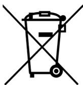
Das nebenstehende Symbol weist auf das Verbot der Entsorgung über den Hausmüll hin. Schadstoffhaltige Batterien/Akkus sind zusätzlich mit den Bezeichnungen für das ausschlaggebende Schwermetall gekennzeichnet: Cd=Cadmium, Hg=Quecksilber, Pb=Blei (Bezeichnung steht auf Batterie/Akku z.B. unter den links abgebildeten Mülltonne-Symbol).
