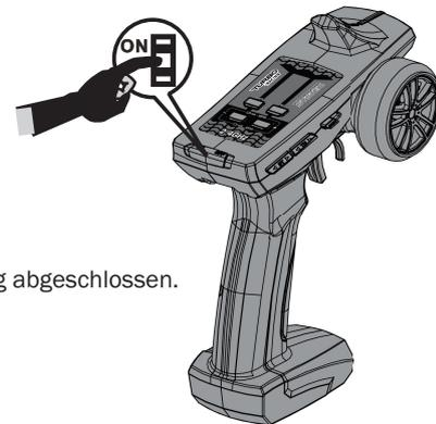
Hinweis: Das Fernsteuersystem in RTR Produkten wurde bereits gebunden. Nur bei der Installation eines neuen Senders oder Empfängers ist der oben beschriebene Vorgang erforderlich.
