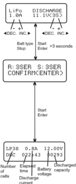
Der Wert des Entladestroms auf der linken Seite darf 1C nicht überschreiten und der Wert auf der rechten Seite darf nicht unter der vom Hersteller empfohlenen Spannung liegen, um eine Tiefentladung zu vermeiden. Drücken Sie die START / ENTER-Taste länger als 3 Sekunden, um die Entladung zu starten.
