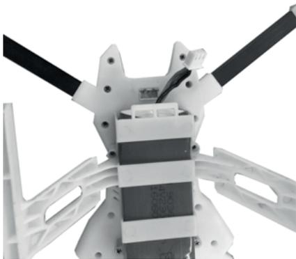
Stecken Sie den Akku in die Halterung auf der Unterseite des Modells. Stecken Sie nun den weißen Akkustecker am Copter an, unbedingt auf richtige Polung achten!
