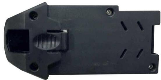
Das Modell ist mit einer steckbaren Kamera ausgestattet. Die Kamera kann durch Drücken des Verriegelungsknopfes herausgezogen werden.
